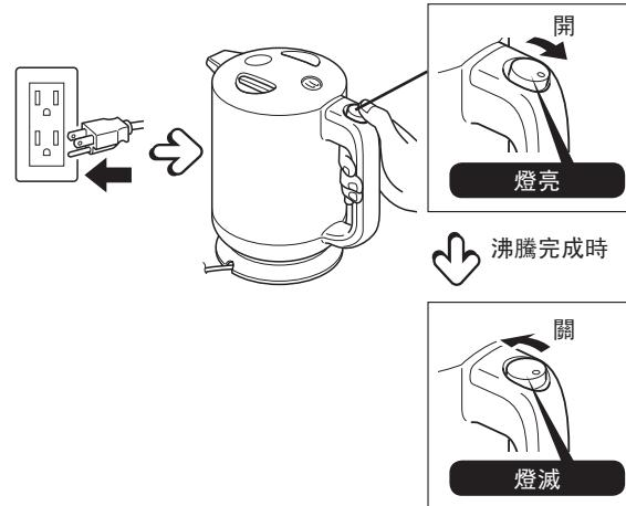
5 請先確認電源開關是否切換為「關」後, 再將電源插座上的電源插頭拔除。
